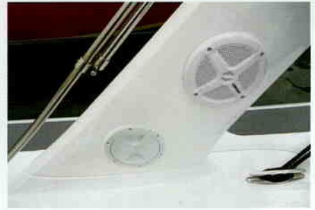
Lautsprecher und Inspektionsluk.
